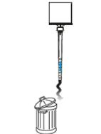
9. Insérer la canule mélangeuse au fond du trou. Injectez la résine et retirez lentement la buse du trou, en évitant de former des chambres d'air dans le trou. Remplissez environ  $\frac{3}{4}$  du trou. Avant de retirer complètement la buse.
